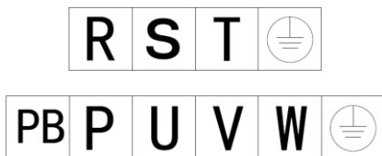
图 3-4 4kW-5.5kW（2020 型）主回路接线端子
